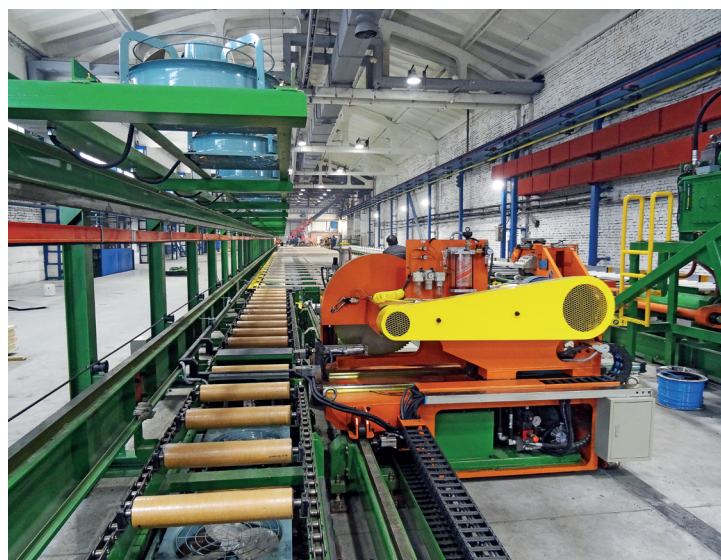
Монтаж выходной линии прессового комплекса усилием 2500 ТС в обновленном цехе.
