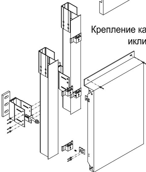
Крепление кассет на алюминиевые кассетные профили
